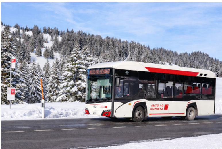
Der neue Elektrobus des Typs Solaris Urbino 9 LE electric im Einsatz auf der Linie 505 über die Ibergereg.
